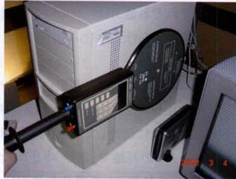
図 1.1 商用電源磁界測定時の様子
