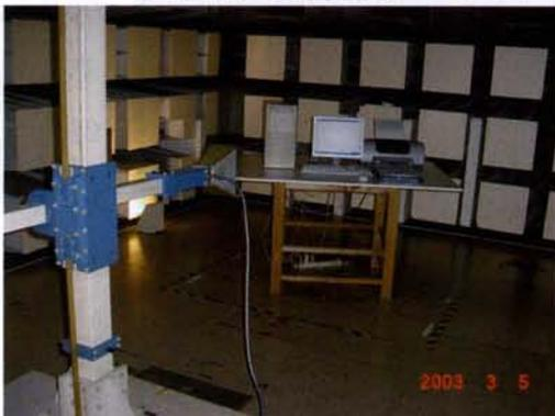
図 1.3 PC からの放射電磁界測定時の配置
