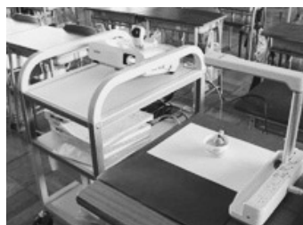
写真3 電子黒板と書画カメラを接続している様子
