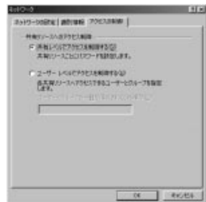
画面3：「アクセスの制御」パネルはインストールしたままの状態でもよい。NTサーバがある場合は、ユーザーレベルでの制御を行うことができる
