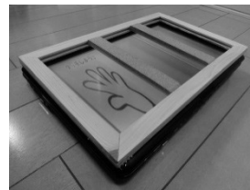
写真1 タッチパネルディスプレイの上にに取り付けた木枠の補助具
