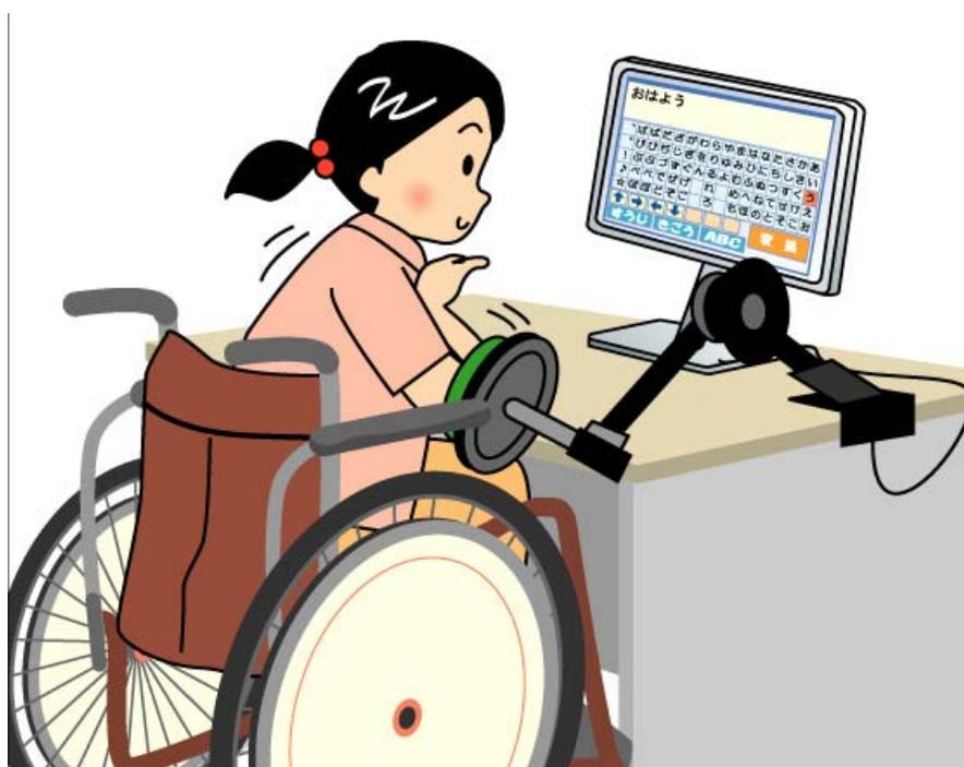
図 9-4 スイッチ操作による障害者用ワープロソフトで文字を綴っているところ
